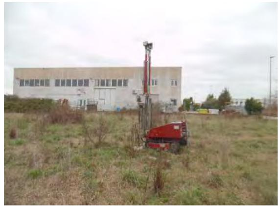
foto 1-2: esecuzione prove penetrometriche dinamiche super-pesanti Dpsh21 e Dpsh23
