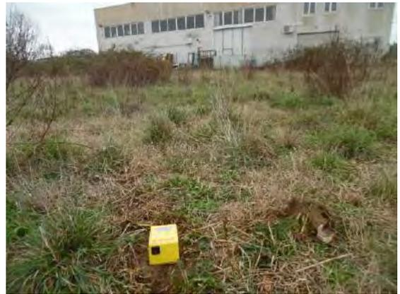
foto 4: esecuzione rilievo sismico passivo con tecnica HVSR e registrazione mediante tromografo digitale
